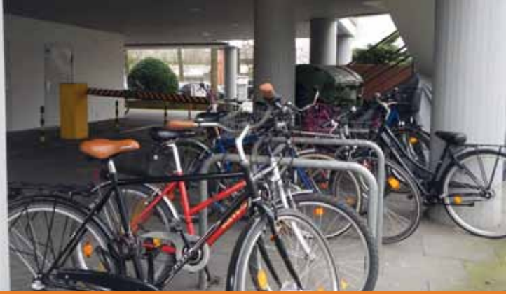
Bild 24: Nachträglich montierte Anlehnbügel in der Erdgeschosszone neben einer Zufahrt zu gebäudebezogenen Kfz-Stellplätzen
